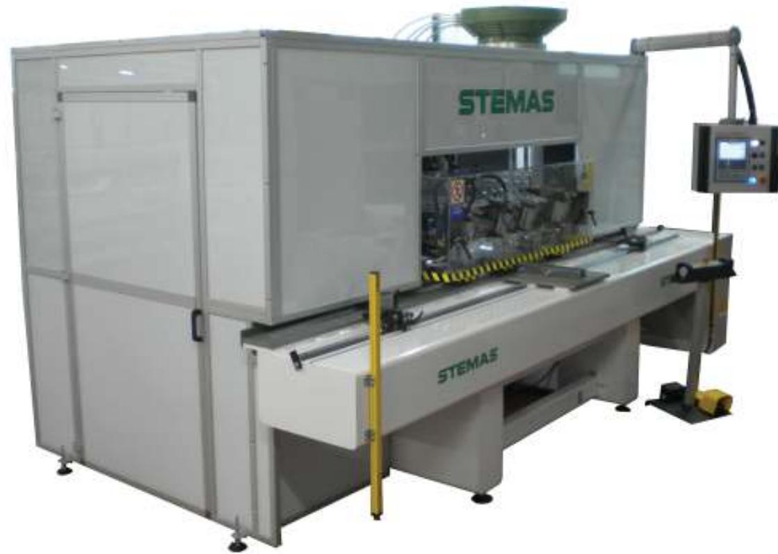
STATISCHE MACHINE VOOR FREZEN, BOREN EN DEUVELEN VAN BEIDE STIJLEN EN REGELS VOOR KEUKENDEUREN
